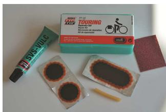
Klassische Reparatursets (bspw. von „TIP TOP“) enthalten sechs kleine, zollgroße (ca. 2,5 cm) kreisförmige und einen doppelt so großen ovalen Flicker. Weiterhin enthalten sie eine Tube mit Kleber (Vulkanisierungslösung), Schmirgelpapier und einen Schlauch zum Abdichten von defekten Universalventilen (s. Abbildung).
